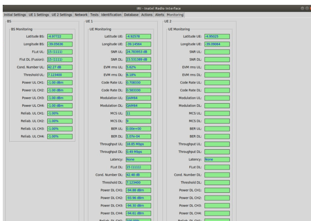
Figura 3: Aba de monitoramento da interface de rádio durante testes de conectividade. A Figura apresenta a atualização em tempo real das métricas de comunicação entre a BS e uma UE, incluindo indicadores de qualidade de enlace e de sensoriamento dos canais.
