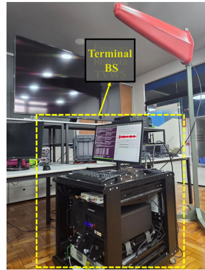
(b) Terminal BS que provê conectividade à UE.
