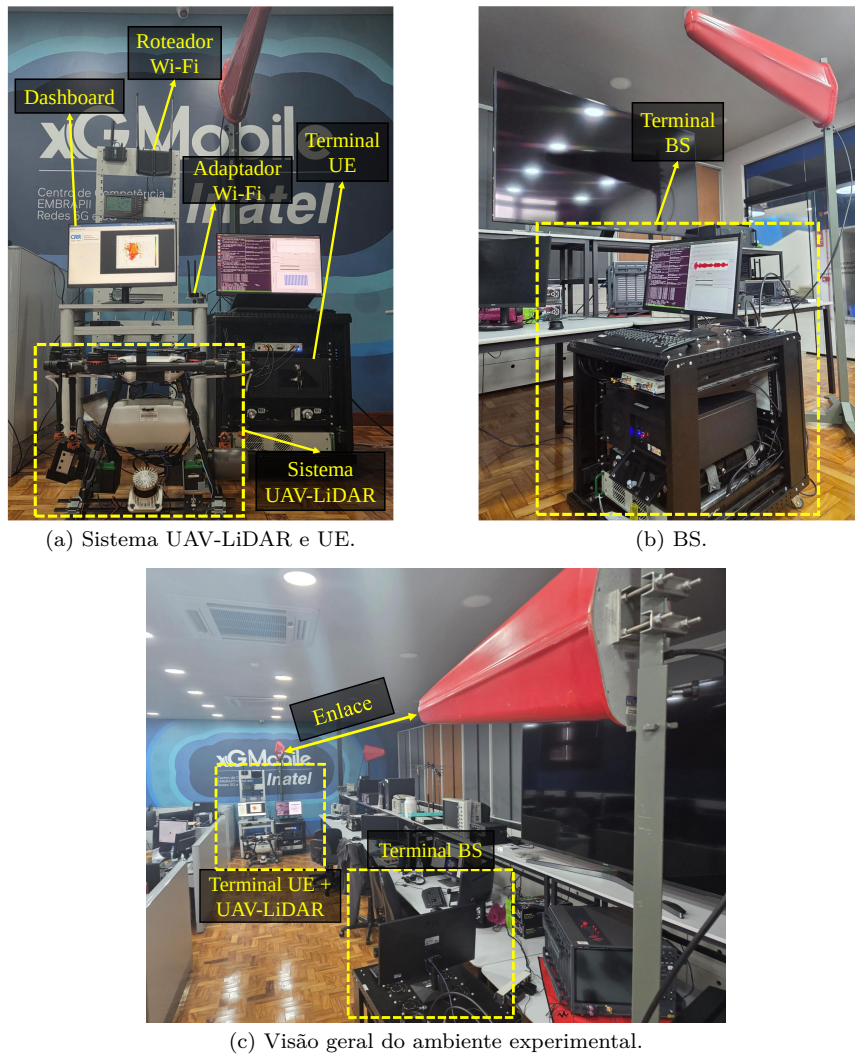
Figura 4: Cenário experimental utilizado para validação da integração entre a aplicação UAV-LiDAR e a rede de acesso Brasil 6G.
