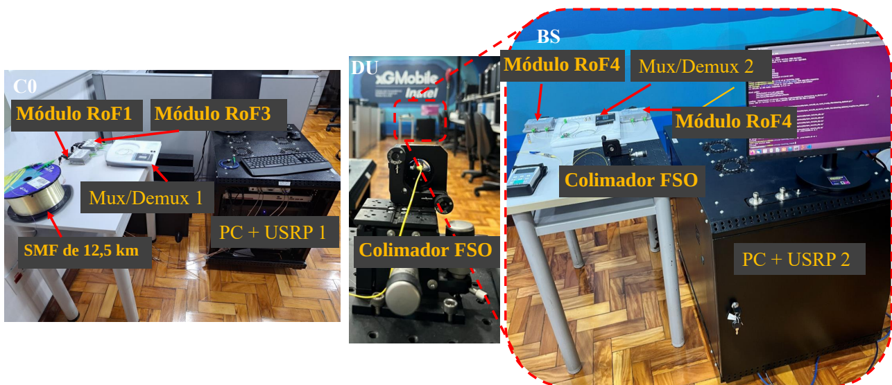
Figura 7: Bancada experimental contendo os principais componentes elétricos e ópticos utilizados na validação do sistema.
