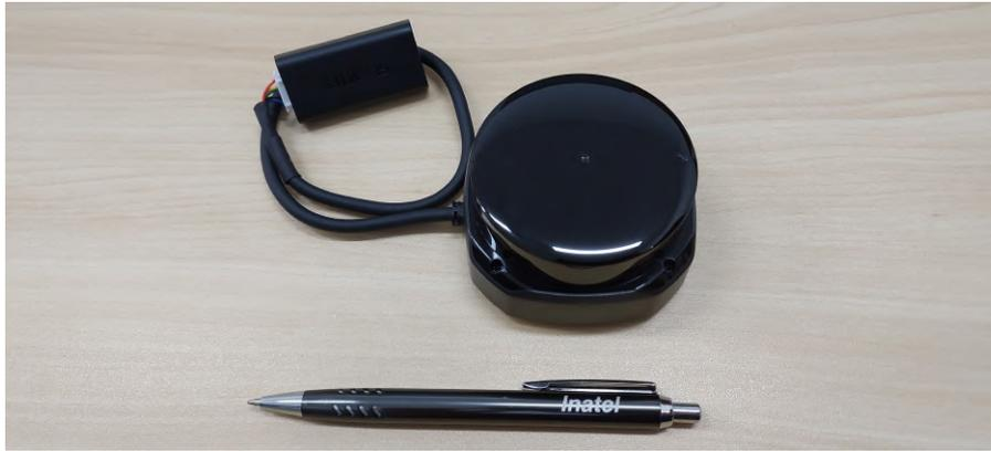
Figura 5: Slamtec LiDAR RPLiDAR S2 utilizado na implementação do sistema [ref].
