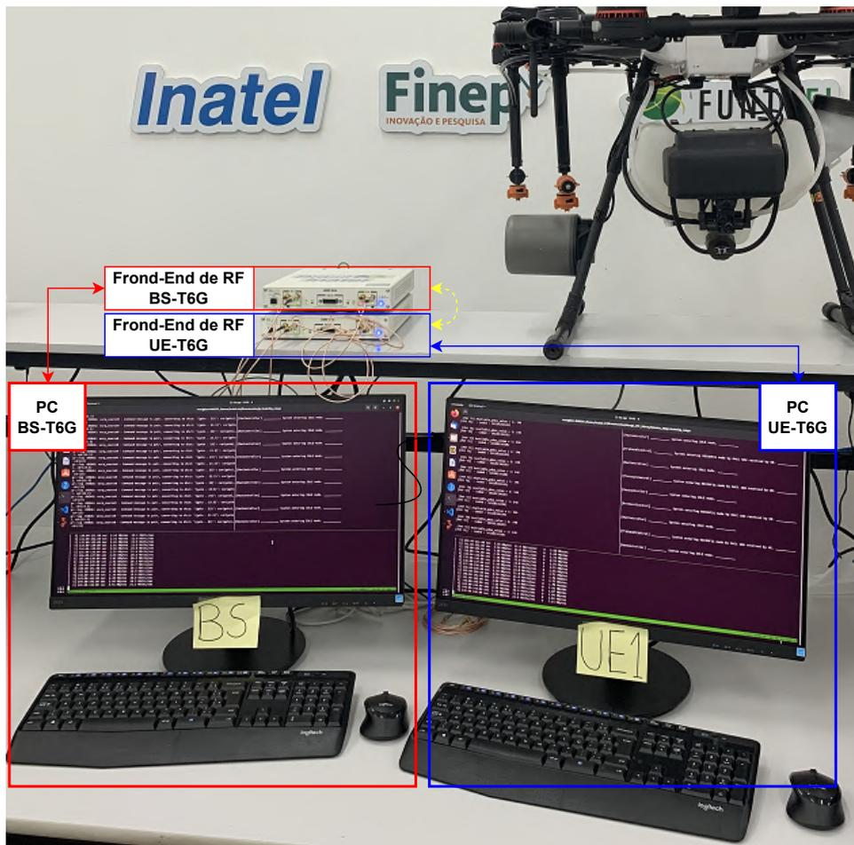
Figura 10: Configuração do ambiente de testes iniciais de integração entre UE, rede de acesso e núcleo da rede Proto 6G considerando cenário real com uso dos transceptores UE-T6G e BS-T6G.
