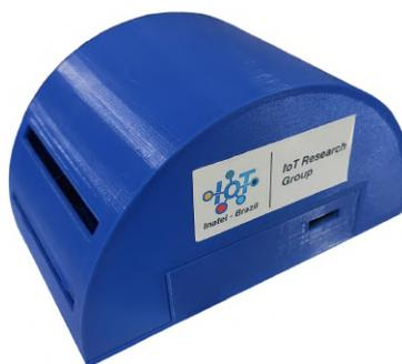
Figura 46: Case impresso em 3D para colar de monitoramento de gado.
