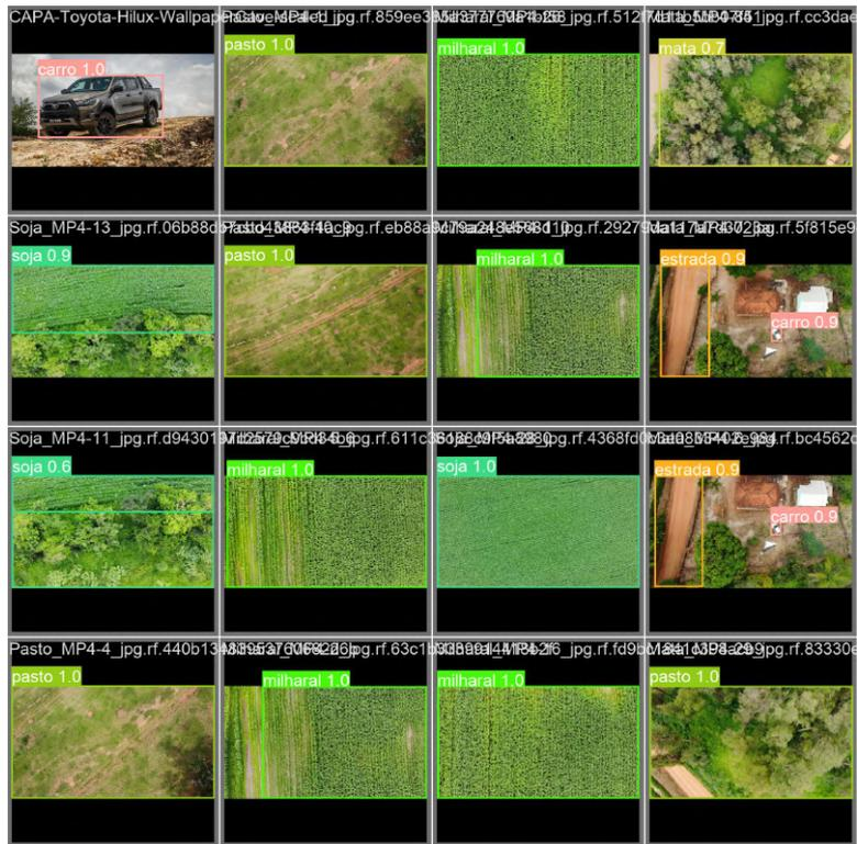
Figura 10: Detecções feitas pelo modelo YOLOv8x.
