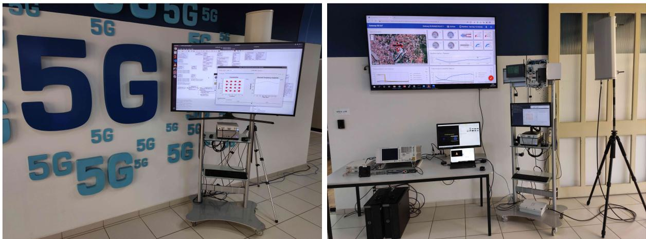
Figura 41: Estação rádio base e terminal de usuário empregados na demonstração da rede 5G-IoT.
