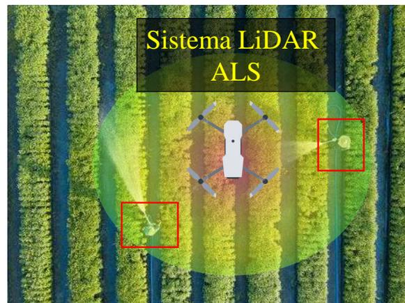
Figura 6: Sistema LiDAR ALS embarcado em drone detectando obstáculos em área agrícola com destaque para objetos identificados entre as linhas de cultivo.
