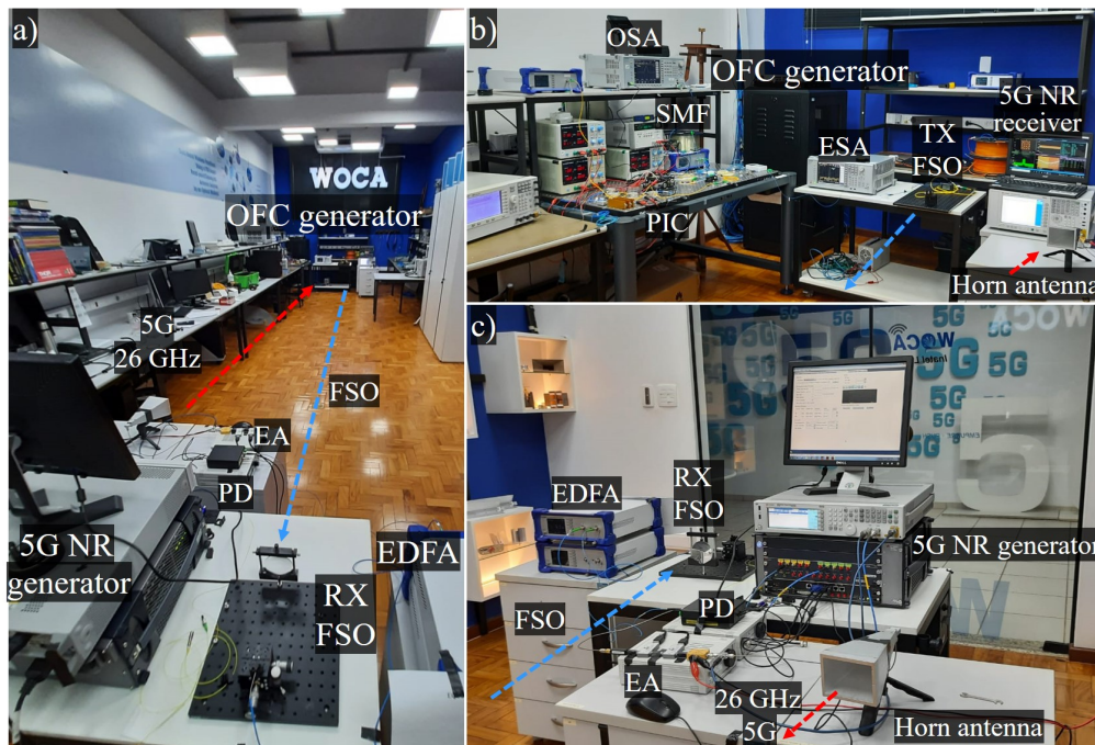
Figura 24: Fotografias da configuração experimental do sistema 5G NR operando em mmWaves baseado no OFC integrado: (a) e (c) mostram as vistas traseira e frontal, respectivamente, da recepção do FSO, o PD seguido pela cadeia de amplificadores elétricos, gerador 5G NR e antena corneta TX; (b) exibe o PIC, enlace óptico seguido pelo transmissor FSO, antena de corneta RX e analisador de sinais 5G.
