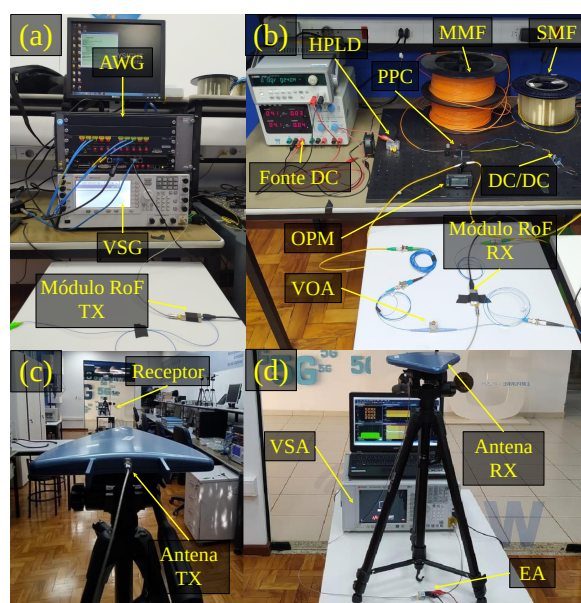
Figura 48: Fotografia do sistema RoF alimentado por PoF: (a) Transmissor RoF; (b) Receptor RoF e enlace PoF; (c) Enlace indoor sem fio de 10 metros; (d) Receptor do enlace sem fio.
