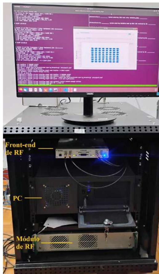
Figura 2: Protótipo montado do transceptor.
