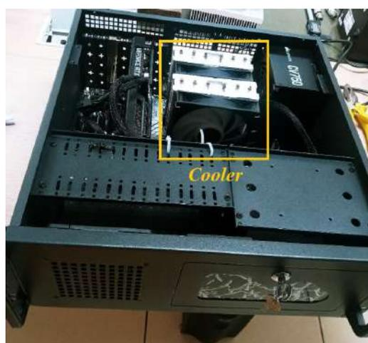
Figura 5: Novo *cooler* para o processador do sistema.
