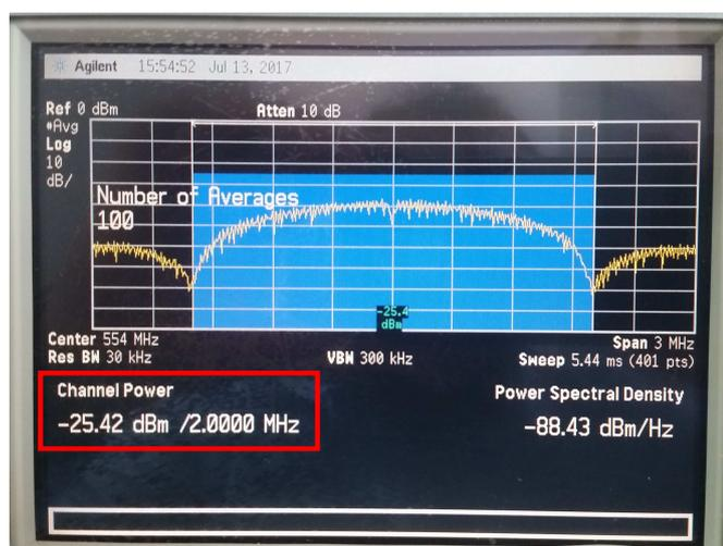
Figura 11. Medição da potência de transmissão da placa USRP via analisador de espectro com  $Tx\_Gain = 40$  dB. Espectro similar ao mostrado em [6, Fig 6.5].
