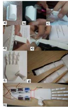
Fig. 7. Montagem da prótese
