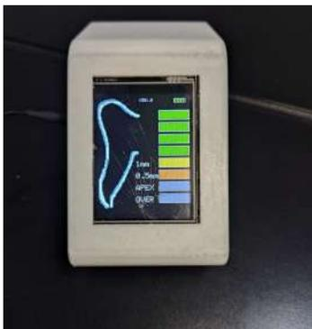
Fig. 1. Interface LCD. Barra de Progresso Exibindo a Medição.
