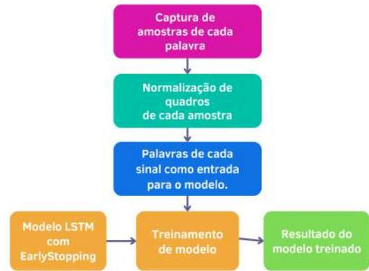
Fig. 4. Diagrama de blocos do processo de treinamento da IA, mostrando as etapas de coleta de dados, pré-processamento, treinamento do modelo LSTM e validação.
