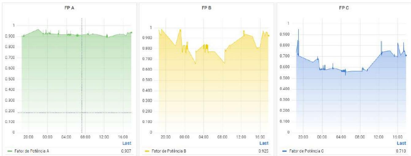
**Figura 7.2.8:** Medição do Fator de Potência nas Fases
