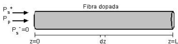
Fig. 3 – Condições iniciais de P_s^+ , P_s^- e P_p .
