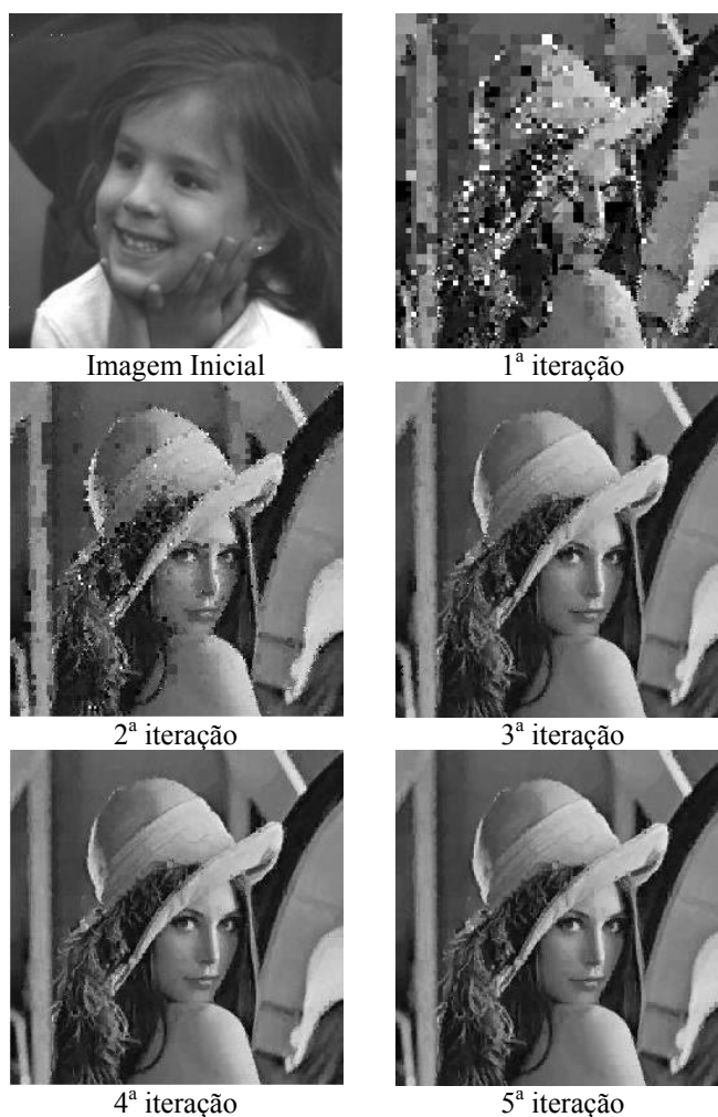
Fig. 7 - Imagem inicial e as 5 primeiras iterações do processo de decodificação (Compressão Fractal - método da partição quadtree).
