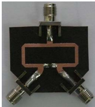
Fig. 32. Protótipo do divisor de Wilkinson utilizado nas medições.
