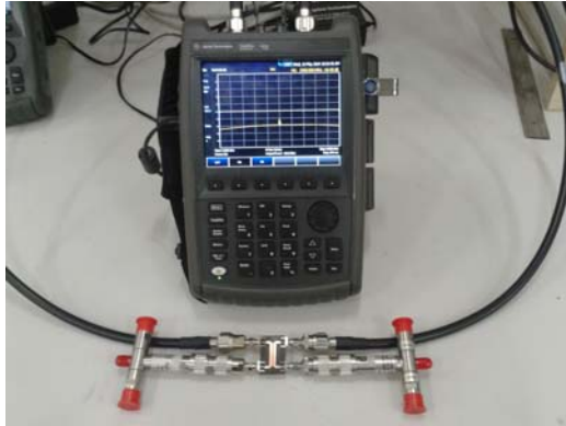
Fig. 9. Imagem de um dos ensaios realizados em laboratório utilizando o FieldFox N9913A 4GHz da Agilent/Keysight Technologies.
